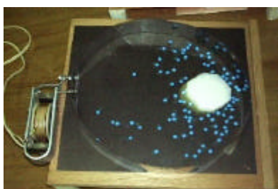
ブラウン運動モデル実験機 (按摩器の振動部分を使って)
