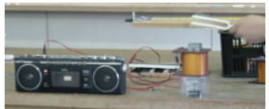
コイルを巻いた磁化した鉄心の上でおんさを振動させると、おんさが磁化し振動するので、
