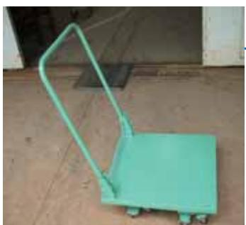
荷台を支える車軸が移動することにより、段差を楽に乗り越えられる仕組みは高く評価され、海外にも貸し出されました。
