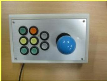
パソコンのマウスとして使います。スティックでポインターを動かし、左のボタンで、クリック操作をします。マウスでポインターを動かしたり、クリックしたりすることが苦手なお子さんが使用しています。
