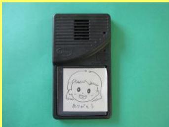
1つの音を録音することができます。絵の部分を押しすと再生します。わずかな力で入力することができ、裏に磁石がついているので、壁などに貼り付けることができます。
