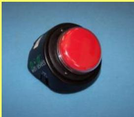
数回に分けて音を録音することができます。ステップバイステップを押す度に、「おはよう！」→「元気？」→「昨日何したの？」など、録音した順番通りに音がでます。
