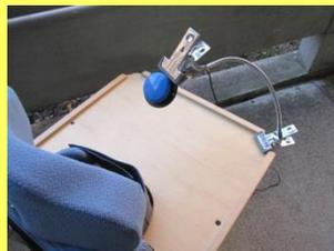
ねじ式とクリップ式の2種類あります。手などの動かし方に合わせて、スイッチを設置する場所を調節することができます。
