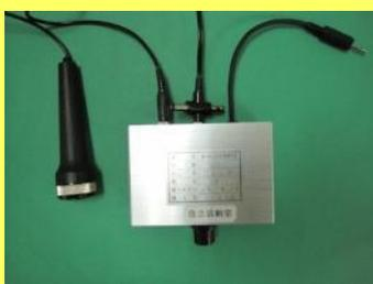
発声によって、スイッチのON・OFFの操作をすることができます。また、声を出し続けている間、スイッチを入れることもできるので、発声練習にもなります。
