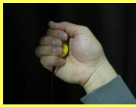
押すタイプのスイッチです。マジックテープなどを使用して、ヘッドレストにつけ、頭で押している方もいます。
