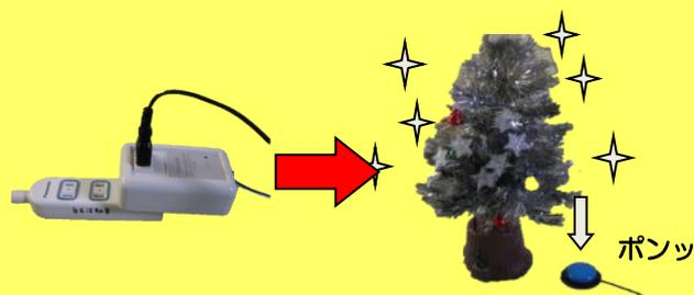
コンセントで使用しているものを、スイッチで動かすことができます。リモコンリレーのコンセントに差し込むだけで使用できます。図は、クリスマスツリーを点灯しているところです。
