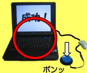
マウスにジャックを付けています。スイッチをつなげて押すと、左クリックの操作をすることができます。
