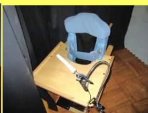
棒を倒すとスイッチが入ります。ダブルクリップを使用していろいろな位置に設置することができます。腕を上げる、腕を外に出すなどの得意な動かし方に合わせることができます。
