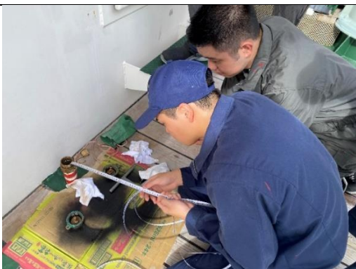
タンクに積み込んだ燃料の計測をしています。
